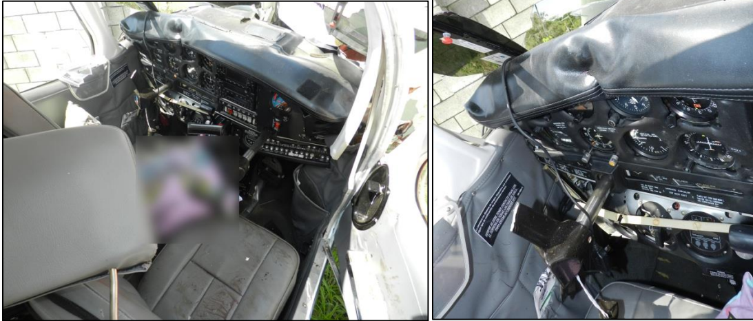
Fotografías No. 10 y 11: Daños en cabina y panel de instrumentos.
