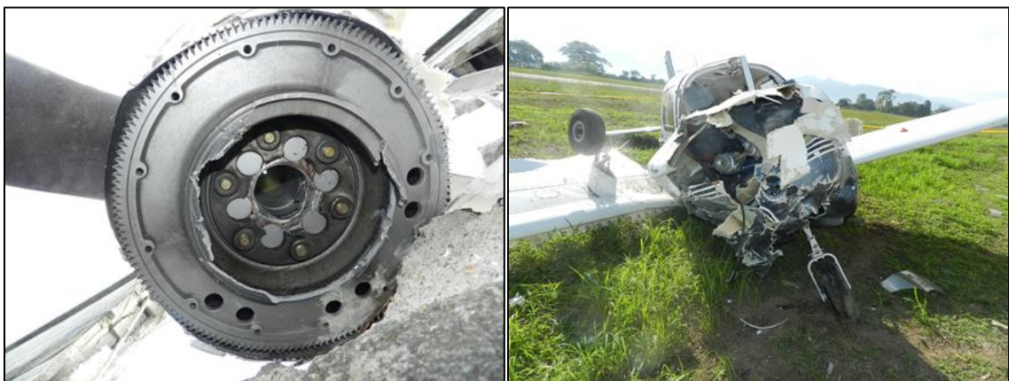
Fotografías No. 3 y 4: Daños en el motor y parte frontal de la aeronave
